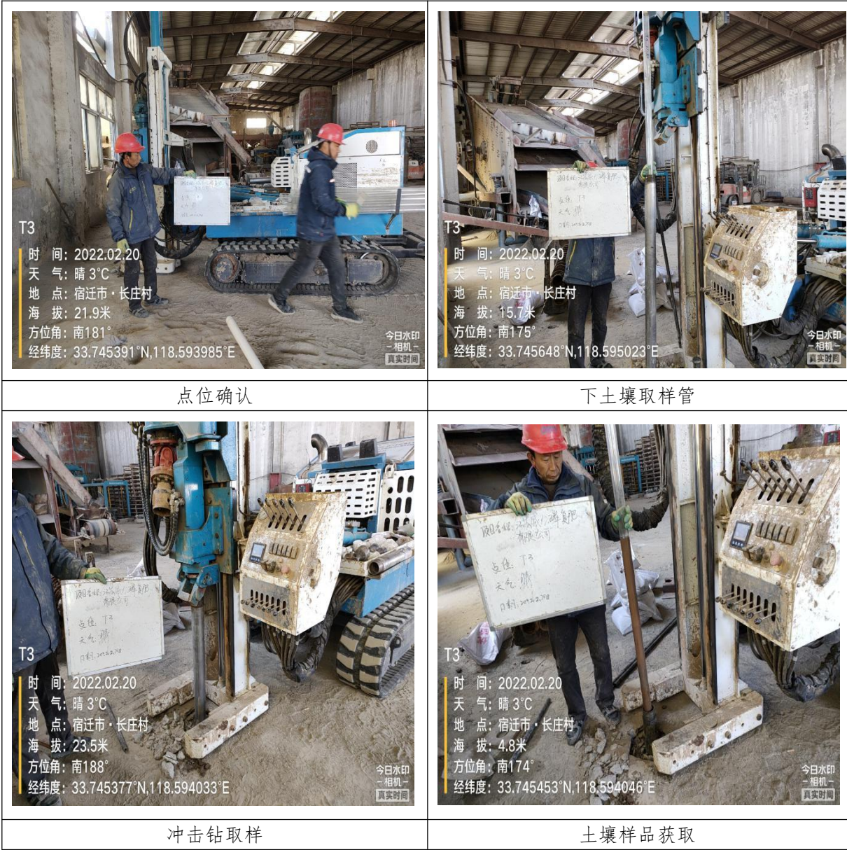
图 7-3 土壤钻孔取样过程演示
