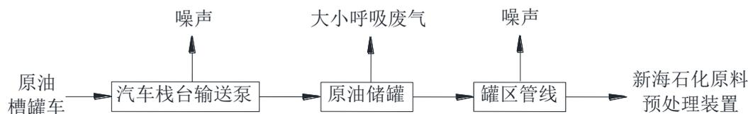
图 3.3-1 原料油储运工艺流程图
