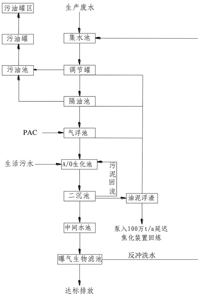
图 7.3-2 新海石化污水处理设施流程
