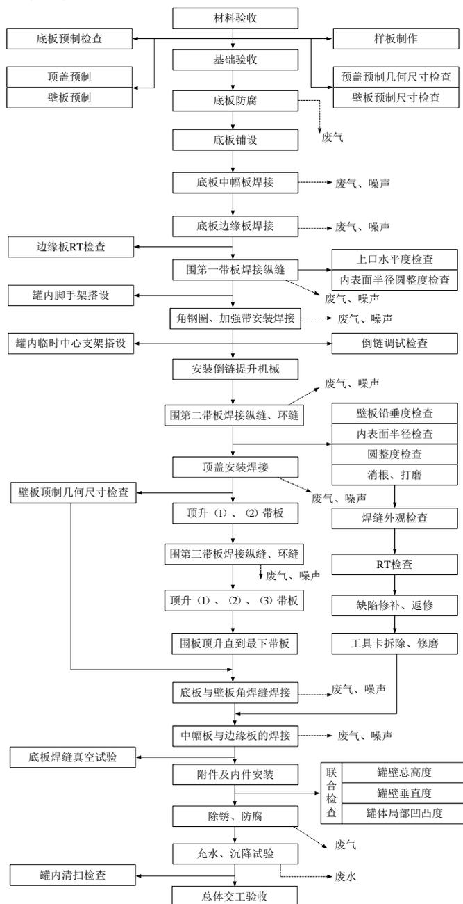
图 4.3-1 储罐制作、安装工艺流程图
