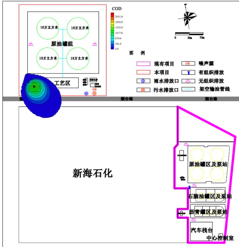
图 6.9-5(b) 事故工况下罐区发生泄漏后 1000 天后 COD 运移平面分布图
