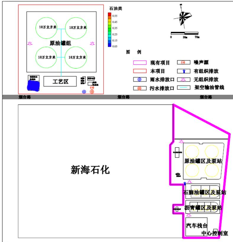
图 6.9-5(d) 事故工况下罐区发生泄漏后 100 天后石油类运移平面分布图
