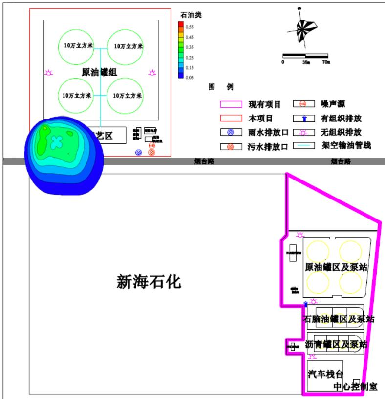
图 6.9-5(e) 事故工况下罐区发生泄漏后 1000 天后石油类运移平面分布图
