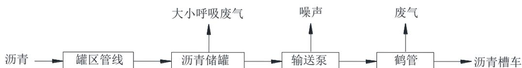
图 3.3-3 沥青储运工艺流程图
