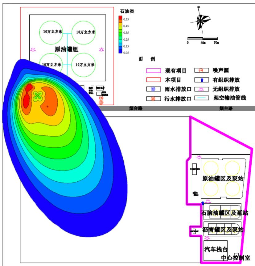
图 6.9-5(f) 事故工况下罐区发生泄漏后 10000 天后石油类运移平面分布图
