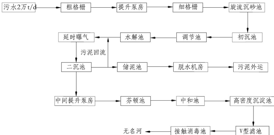
图 7.3-3 柘汪临港产业园区污水处理厂工艺流程示意图
